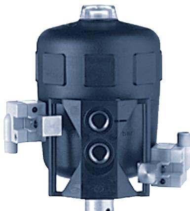
Los sensores magnético-inductivos reaccionan a la aproximación del pistón magnético de las válvulas de diafragma o de asiento accionadas por pistón de las series 2XXX. De este modo, con un LED se puede visualizar óptica o eléctricamente la posición del pistón. Además, este sistema permite utilizar un limitador de carrera o un mando manual.
