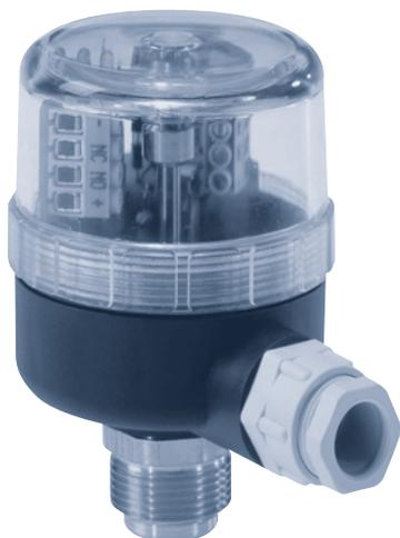
El indicador de posición eléctrico, Tipo1062, muestra el estado de la posición de una válvula (todo/nada) en aplicaciones de válvulas de proceso con accionamiento neumático rotativo o de carrera de las series 20XX y 26XX. La posición de las válvulas se indica por medio de LED.
