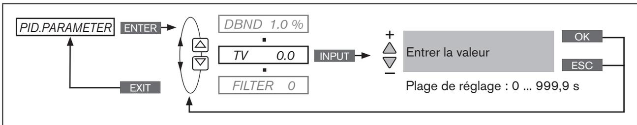
Figure 46 : Structure de commande TV ; durée d'action dérivée
