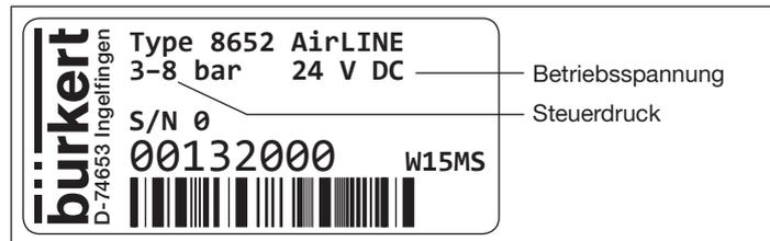
Bild 2: Beispiel eines Typschilds Ventilinsel Typ 8652
