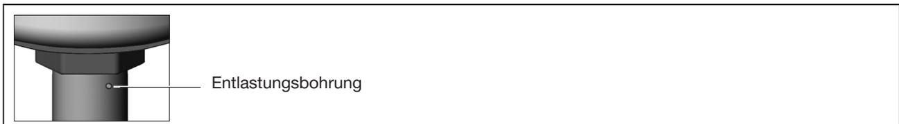
Bild 7: Entlastungsbohrung
