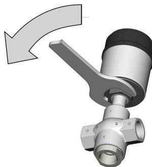
Bild 5: Antrieb drehen
