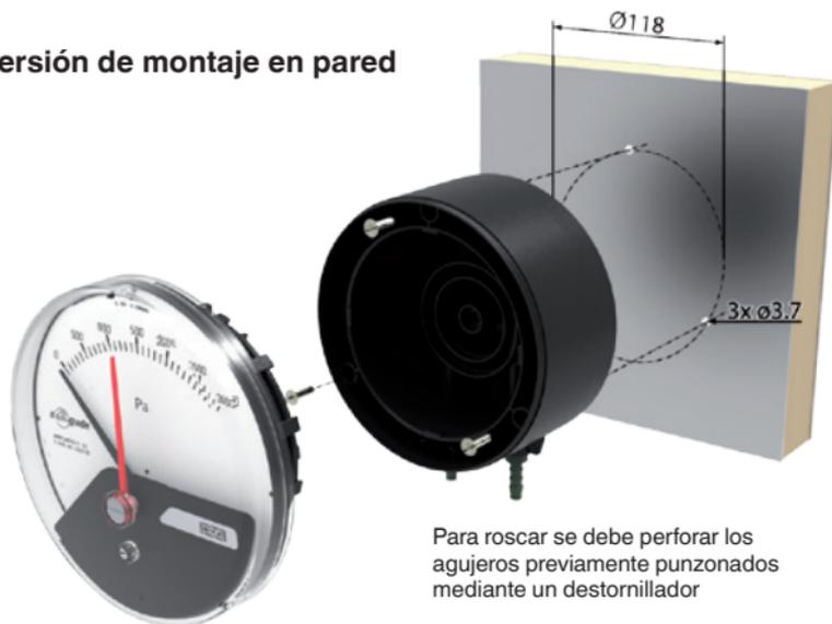
Para rosar se debe perforar los agujeros previamente punzonados mediante un destornillador
