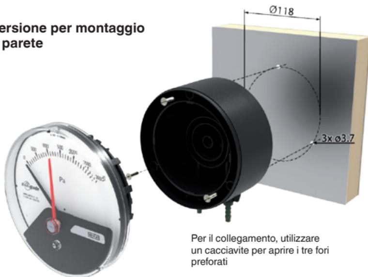
Per il collegamento, utilizzare un cacciavite per aprire i tre fori prefatti
