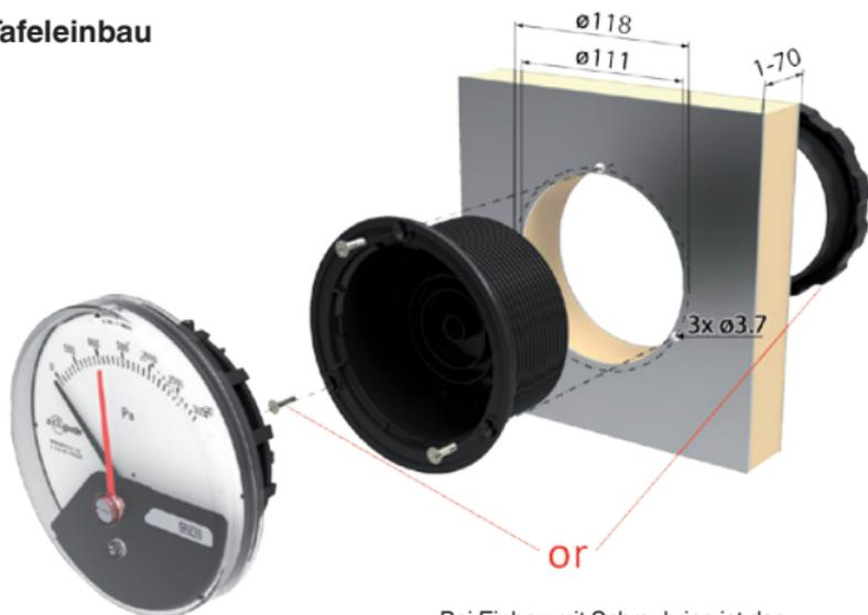
Bei Einbau mit Schraubring ist das Durchstoßen der Löcher nicht notwendig
