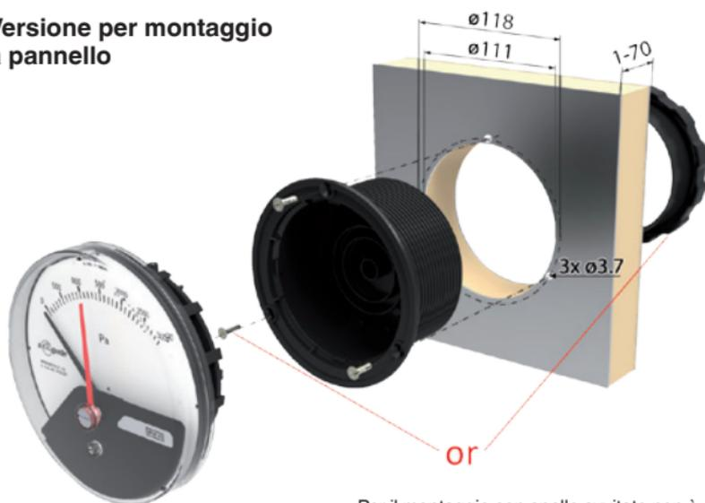
Per il montaggio con anello avvitato non è necessario aprire i fori
