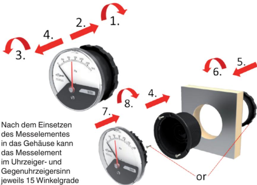
Nach dem Einsetzen des Messelementes in das Gehäuse kann das Messelement im Uhrzeiger- und Gegenuhrzeigersinn jeweils 15 Winkelgrade verstellt werden um eine exakte waagrechte Positionierung des Gerätes zu gewährleisten.
