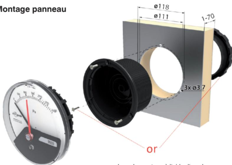
Lors du montage à l'aide d'une bague filetée, il n'est pas nécessaire de percer les trous
