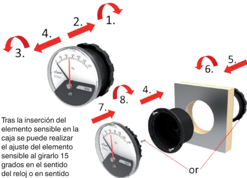
Tras la inserción del elemento sensible en la caja se puede realizar el ajuste del elemento sensible al girarlo 15 grados en el sentido del reloj o en sentido contrario para asegurar una posición horizontal del instrumento.
