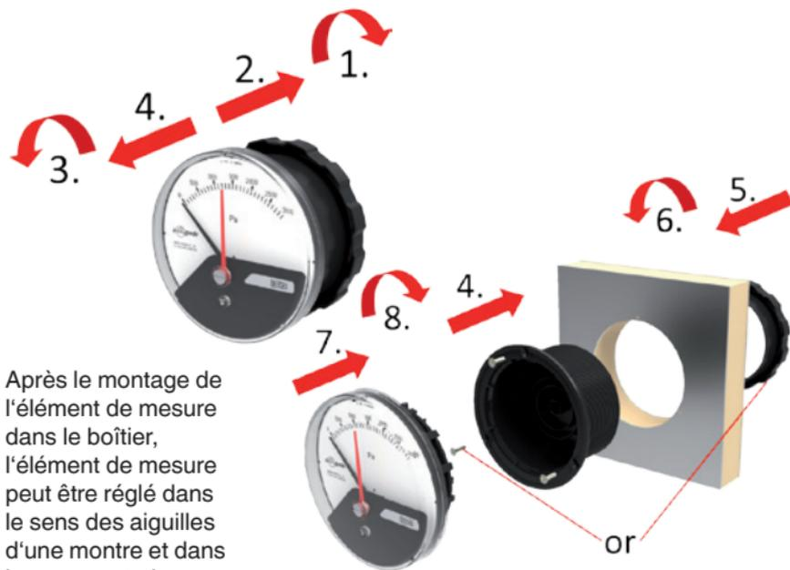
Après le montage de l'élément de mesure dans le boîtier, l'élément de mesure peut être réglé dans le sens des aiguilles d'une montre et dans le sens contraire
