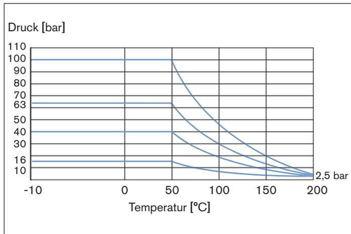
Bild 2: Druck/Temperatur-Diagramm Edelstahlgehäuse (Typen 2651, 2654, 2654 Hygienic, TKU 001)
