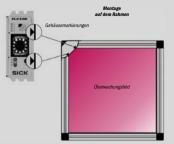
Bei der Montage im Rahmen entstehen prinzipbedingt nicht überwachte Bereiche. Dies kann zur Nichterkennung von Obiekten führen. Sie können die nicht überwachten Bereiche mit Hilfe eines Testobiektes ermitteln.
