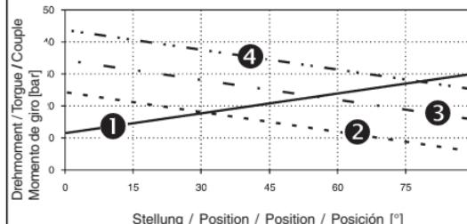
0°: Kugelhahn geschlossen / Ball valve closed / Robinet à boisseau sphérique fermé / Liave esférica cerrada
