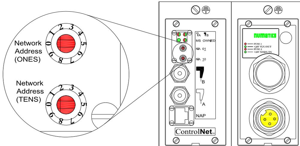
Les roues codeuses permettent à l'utilisateur de régler l'adresse du nœud.
