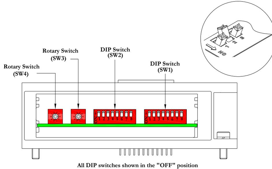
Le MCM (module de configuration manuelle) permet à l'utilisateur de tester manuellement l'îlot Numatics en utilisant le mode auto-test. Le MCM est équipé de deux ensembles de DIP switches (SW1 et SW2) et de deux roues codeuses (SW3 et SW4).
