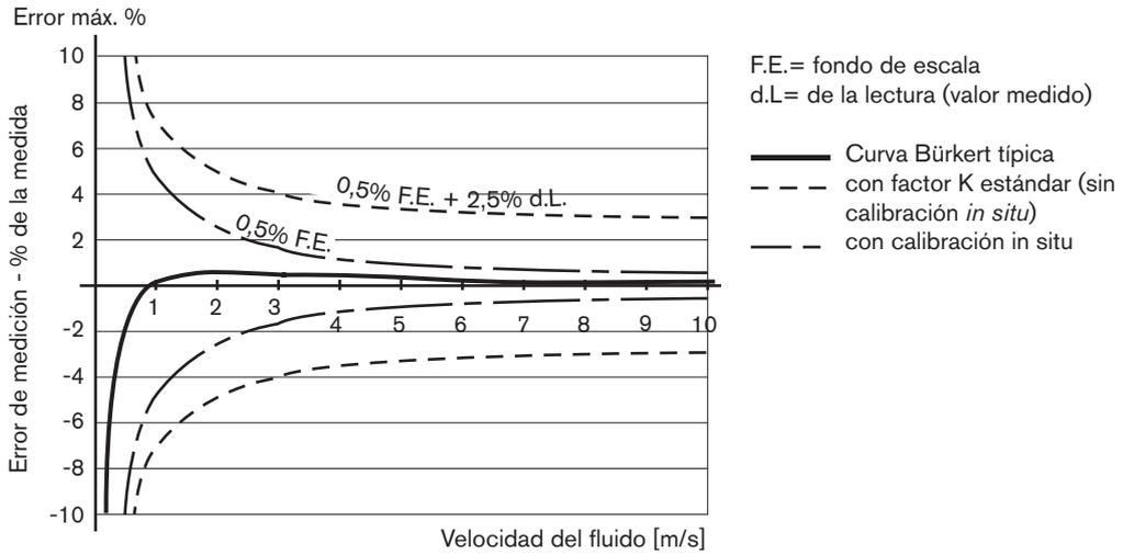
Estos valores se han determinado en las siguientes condiciones de referencia: fluido de medición = agua, temperatura ambiente y del agua = 20 °C; respetando unos tramos rectos de tubería mínimos aguas arriba y aguas abajo, dimensiones de tubería adecuadas.
