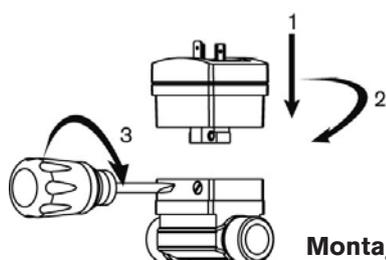
Montaje del sensor SE30 Ex en un fitting S030.5
