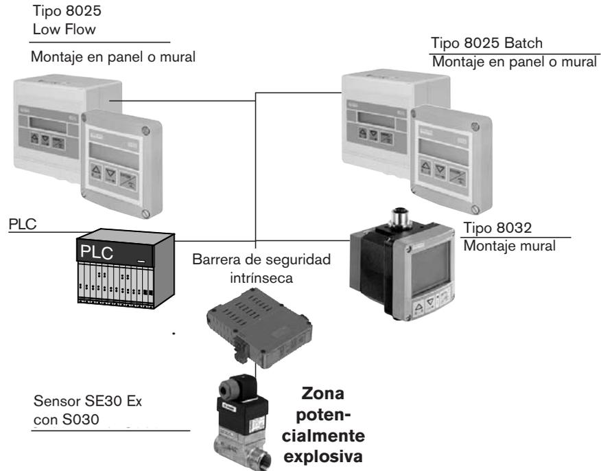
6.2 Ejemplo de conexión con el sensor SE30 Ex y una barrera de seguridad intrínseca con alimentación externa
