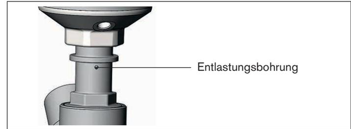
Bild 15: Entlastungsbohrung
