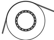
Die Umlenkrolle sollte immer leichtgängig montiert werden. Im Idealfall hat die Umlenkrolle ein integriertes Kugellager.
