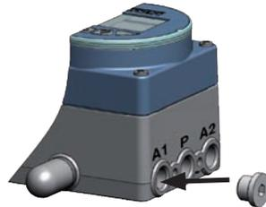
Raccord d'alimentation A2 sur l'actionneur
