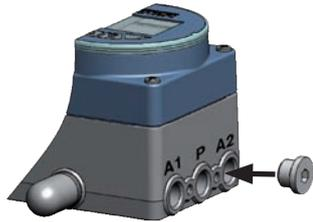
Raccord d'alimentation A1 sur l'actionneur
