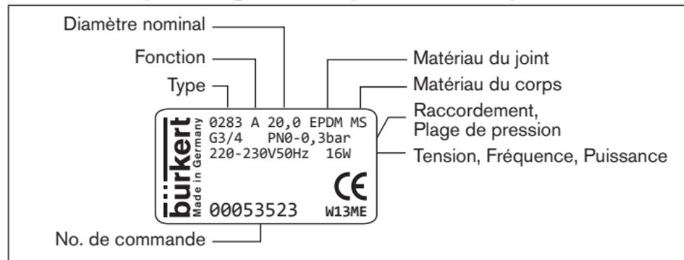
Fig. 1 : Plaque signalétique type 0283 (exemple)
