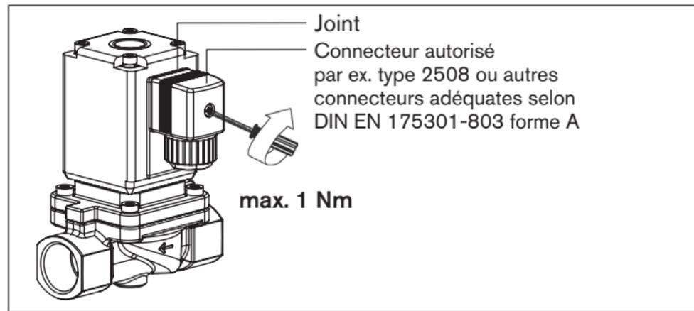
Fig. 4 : Raccordement électrique du connecteur
