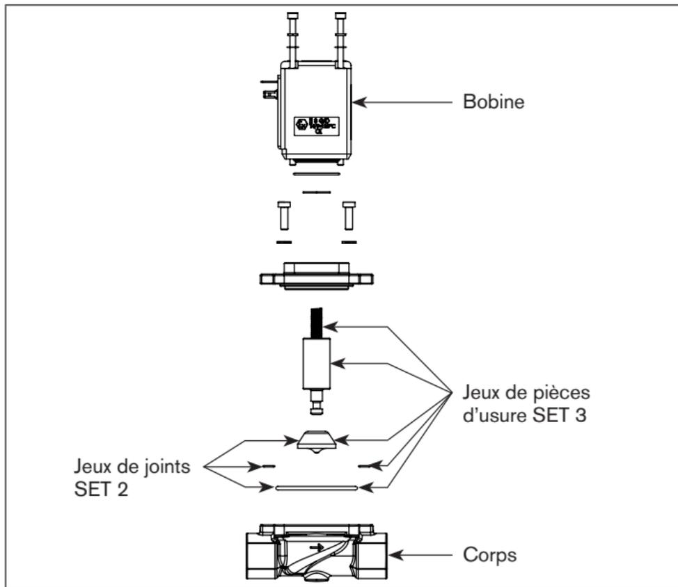
Fig. 5 : Aperçut jeux de pièces de rechange Type 0283
